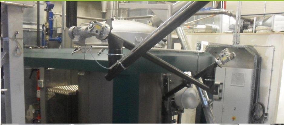
Holzpellet-Pyrolysereaktor mit Holzpellet-Holzgas-BHKW
