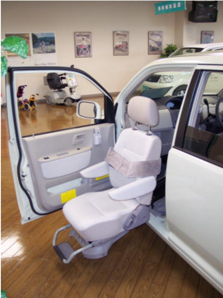
Abbildung 7: schwenkbarer, höhenverstellbarer Sitz bei Mitsubishi
