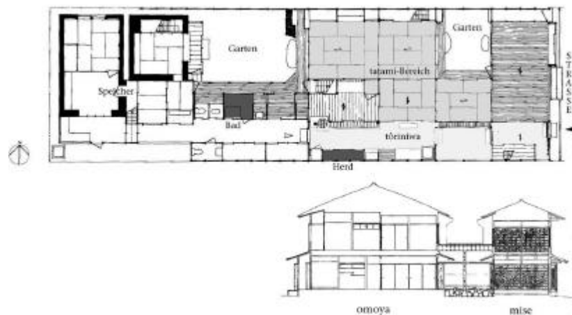
Abb. 2: Grund- und Aufriß eines kyō-machiya des omoyazukuri -Typs
